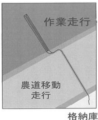
図10 ロータリ耕うん作業時のロボット走行軌跡
