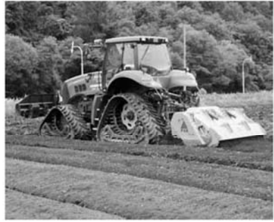
ストーンクラッシャー工法施工の様子
